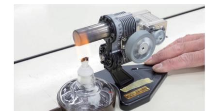
ねじの締め方一つで回転速度や振動が変わるスターリングエンジン。ものづくりの楽しさと難しさを体感します
